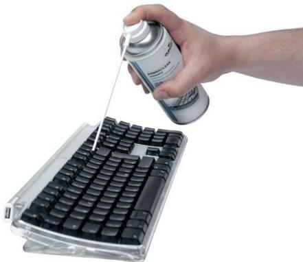
Вы можете применить грушу или любое другое не слишком мощное устройство для направленного потока сжатого воздуха, чтобы выдуть пыль из-под клавиш. Обычно помогают банки с прессованным воздухом.
